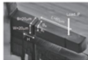
図3 微小試験片によるき裂進展抵抗測定 (Sci.Rep. 2015)
