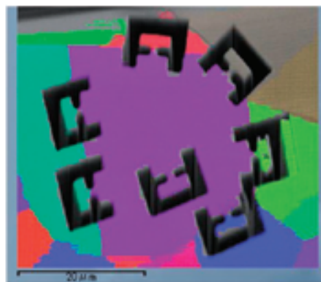
図3 微細加工技術による焼結のマイクロ力学原理の検証実験
