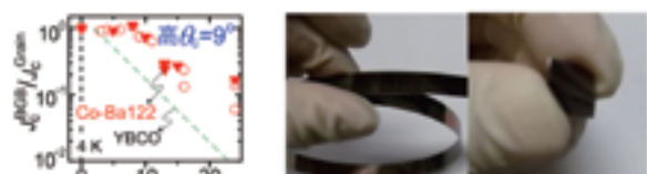
図 4. 高品質 \text{BaFe}_2\text{As}_2:\text{Co} 薄膜により明らかになった鉄系超伝導体の銅酸化物よりも優れた粒界特性 (左) と開発した薄膜線材の写真 (右)。
