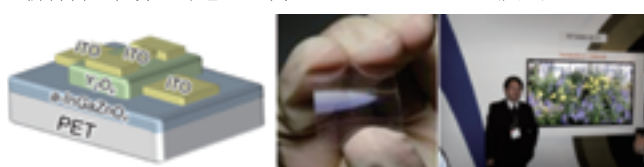
図 7. アモルファス酸化物半導体を用いた薄膜トランジスタ (TFT) は、現在まで使われているアモルファスシリコンよりも 20 倍の移動度など多くの優れた性能を示し、作製も容易なことから次世代の薄型 TV を駆動する TFT の本命と目されている (左: TFT の構造, 中央: プラスチック基板上に作製した TFT の写真)。右の写真は、これを使うことで実現した 70 インチ超高解像 3D-LCD。
