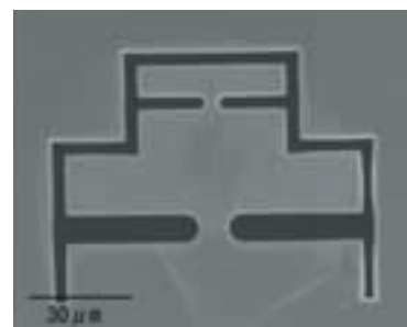
図3 微細加工技術による焼結のマイクロ力学原理の検証実験
