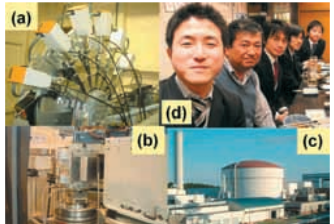
図1 八島研が中心になって開発してきたオンリーワンの高温精密構造解析システム群。(a)多連装放射光回折計に設置した新型高温加熱装置(4B2@KEK)。原研の研究用原子炉(c)の高温中性子測定システム(b)(HERMES@東北大)。(d)大阪にて皆で学会発表した後の飲み会にて。
