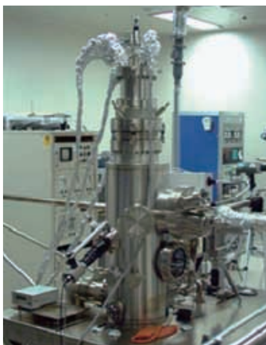
図1 電子状態を原子分解能で観測するための超高真空低温走査トンネル顕微鏡
