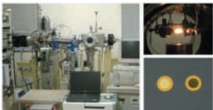
図1 (左) 酸素ラジカル放出とその照射・評価のための実験装置 (右上) 白熱した放出源と四重極質量分析計 (右下) 水晶振動子上での銀の酸化
