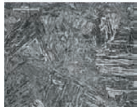
図2 鋼の変態組織の例 上：フェライト（白い部分）＋ベイナイト 下：マルテンサイト
