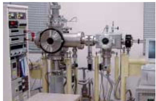
図2 負イオン放出とその照射評価のための真空装置
