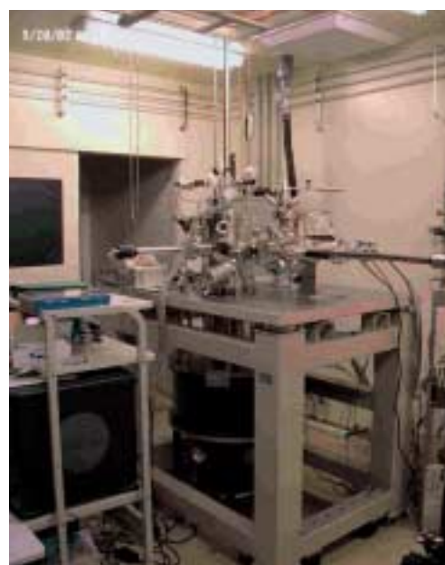
図 2 量子ドットを 1 個ずつ分離して観測するための低温強磁場近接場光学顕微鏡
