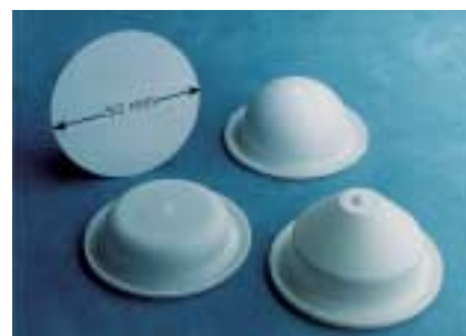
図3 セラミックスの超塑性成形
