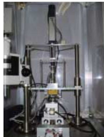
図2 自作したナノインデンター (特許公開中)。圧子直下に発生する高応力場での力学特性が評価できる。
